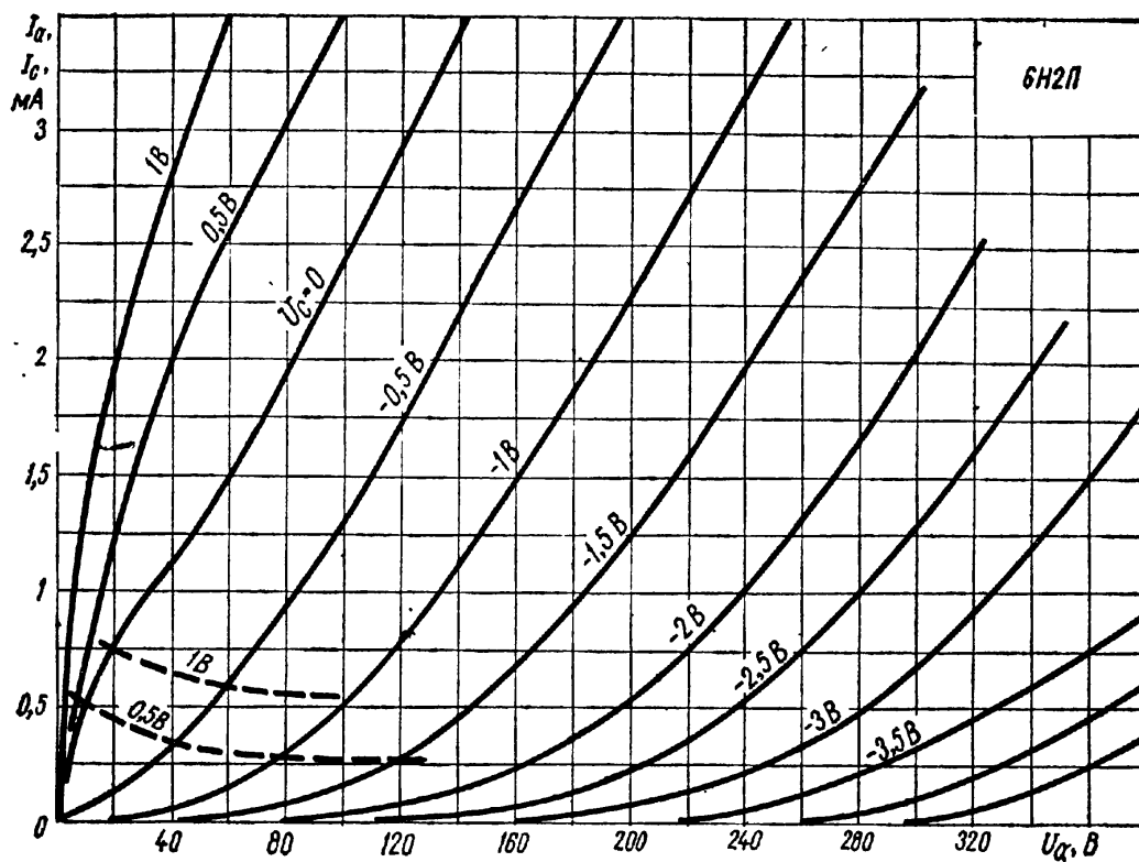
Рис. 22. Усредненные анодно-сеточные характеристики 6Н2П: — ток анода; - - - ток сетки
